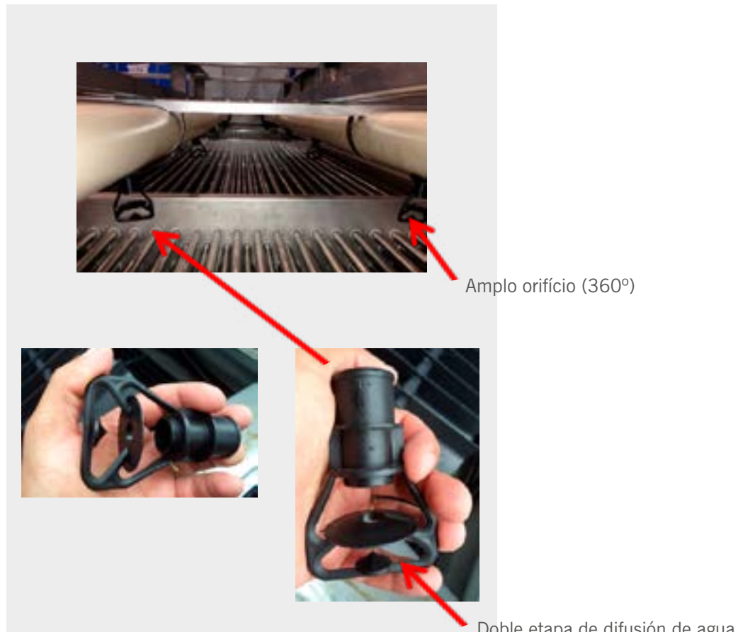
Imagen 49: Posición y distribución de agua de las boquillas aspersores
